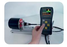
**TA35-UK:**Das Zubehörset für die Transmissionsmessung (z.B. Folien, Kunststoffplatten, Flüssigkeiten, Lacke etc.)
