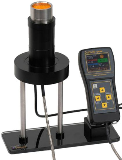
Spektralphotometer sph900 mit MA38-Messkopfadapter und Halterung
