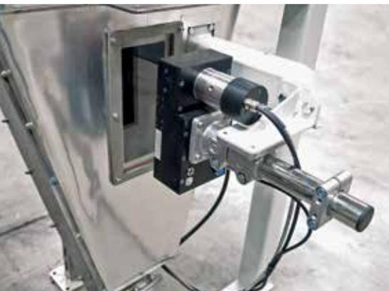
Bild 1. Online-Spektralphotometer misst berührungslos die Farbe von Recyclingmaterial.
