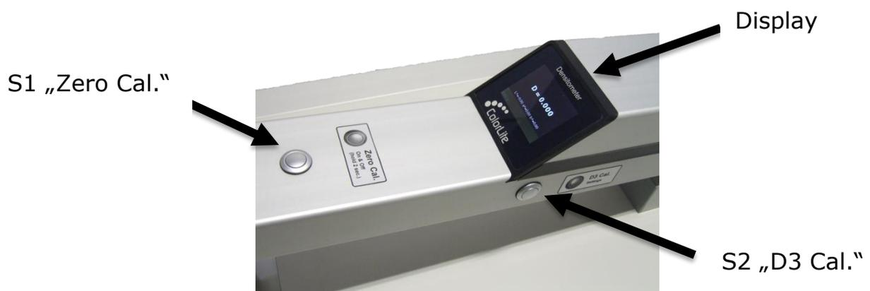
(Fig.: 2-Densitometer arm)
