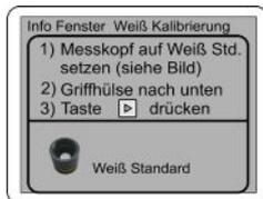
Setzen Sie die Kalibrierkappe mit dem PTB-Standard auf den Messkopf und drücken Sie die Griffhülse ganz nach unten. Um die Kalibrierung zu starten, betätigen Sie die Taste **„ENTER“** [Right Arrow].
