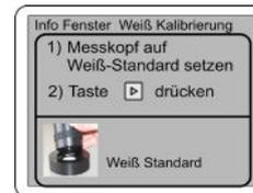
Platzieren Sie danach den d/8° Messkopf auf der weißen Kalibrierfläche des PTB-Standards und betätigen Sie wiederum die „**ENTER**“-Taste am Gerät.
