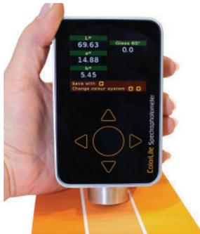
Abb. - XS1 mit dem 45°/0° Messkopf und Probe
