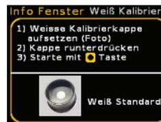
Setzen Sie die Kalibrierkappe mit dem Weißstandard auf den Messkopf und drücken Sie das Gerät ganz nach unten. Um die Kalibrierung zu starten, betätigen Sie die Taste „**Mitte**“ .
