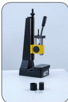
Abb. 2: Pulverpresse mit Hülse und Stempel
