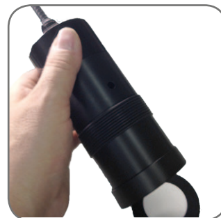
Abb. 1: Messkopf d/0°, Messfläche: 38 mm für inhomogene Proben
