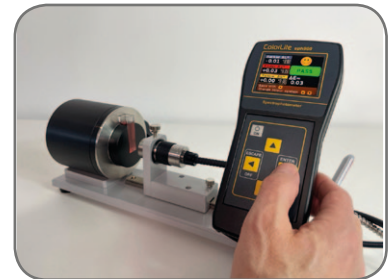
Abb. 1: Messen im Transmissionsmodus mit dem TA35-UK
