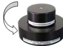
Abbildung 1 – MA35-UK BAM-Standard mit aufgeschraubter Schwarzreferenz
